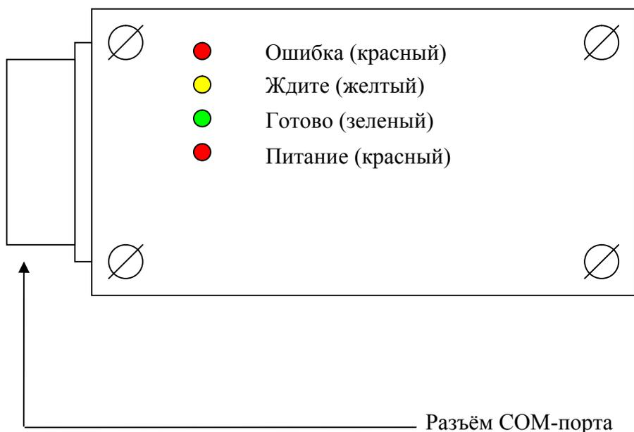
Рисунок 9.1. Внешний вид модуля переноса данных.
