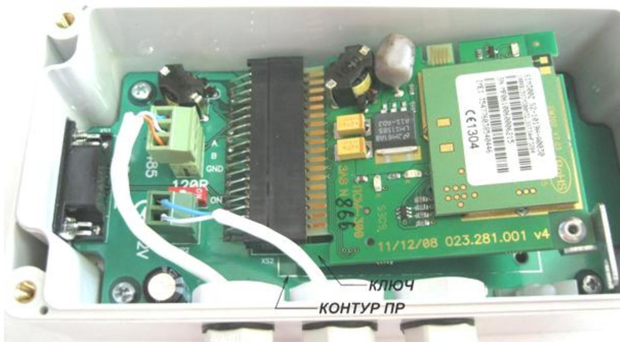
Рисунок 12.7. Установка ПР теплосчетчика в УППР.
