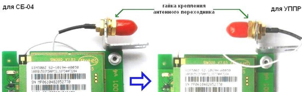
Если разъем антенного переходника на плате GSM модема находится в положении, указанном на рисунке слева, то для установки в УППР его необходимо переставить в положение изображенное на рисунке справа (в этом положении стенка корпуса УППР не будет мешать завинчиванию разъема антенны в разъем антенного переходника).
