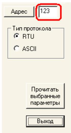
Рисунок 4.4 Настройка адреса в сети MODBUS.
