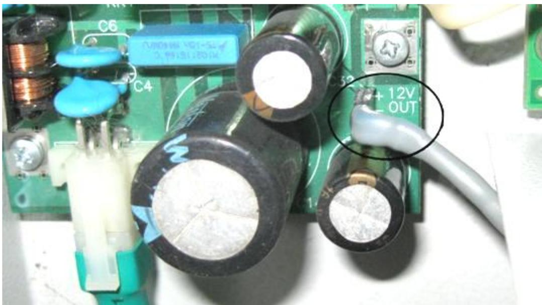
Рисунок 12.5. Подключение кабеля питания к ИП.
