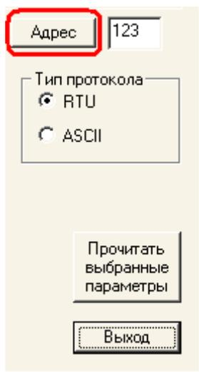
Рисунок 4.5 Вызов окна «Настройка адреса в сети MODBUS».
