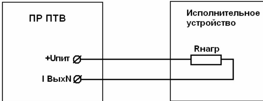
Рисунок 7.2 Подключение исполнительного устройства к токовому выходу.
